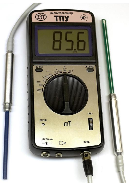
Измерительные зонды с преобразователями Холла: аксиальный (зонд «С») и радиальный (зонд «М»).
