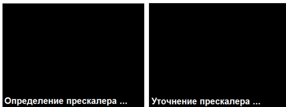
Рисунок 2.12. Сообщения на различных этапах поиска частоты в режиме автоматического поиска частоты основной гармоники
