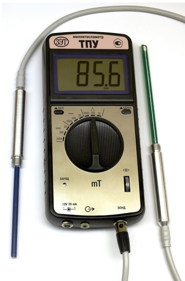
Рис.1. Внешний вид миллитесламетра портативного универсального ТПУ
