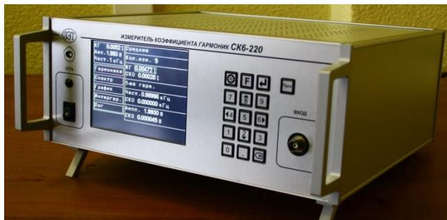
По принципу действия и основным характеристикам СК6-220 аналогичен калибровочному измерителю СК6-20. Управляется встроенным процессором и не нуждается в компьютере. Динамический диапазон до 50 В и может быть расширен до 150 В. Измеряет уровни интергармоник и субгармоник сигнала. По измеренным значениям коэффициента гармоник вычисляет и индицирует коэффициент нелинейных искажений.
